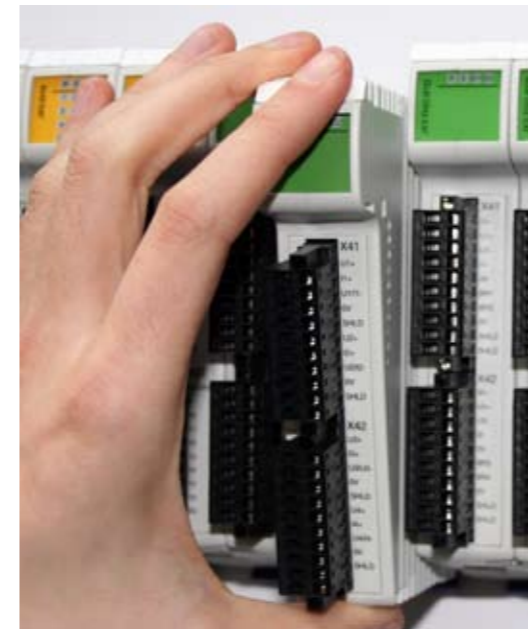
Mit wenigen Handgriffen ist ein Modultausch ausgeführt. Das neue Modul wird anschließend automatisch erkannt.
