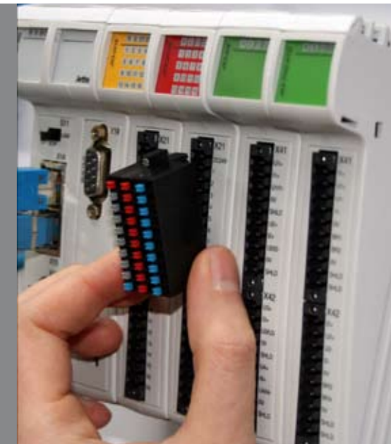
Mit wenigen Handgriffen ist ein Modultausch ausgeführt. Das neue Modul wird anschließend automatisch erkannt.
